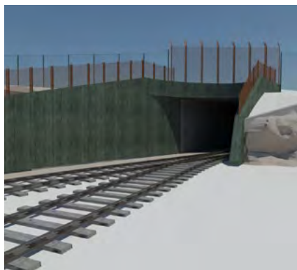
Bild 7. Intrångsskydd ny tunnelbana i Stockholm. Tunnelmynningar framhävs och görs säkrare mot intrång genom att lackad sträckmetall används istället för vanligt flätverksnät. Material plattstål 100x10 samt sträckmetall 115x44x3 mm, höjd totalt 2,3 meter, pulverlackas i för anläggningen genomgående kulör. Källa: Lundell Arkitekter, www.lundellarkitekter.se .
